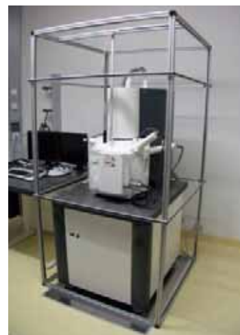
Integrierter Spulenrahmen von Bilz zur Magnetfeldkompensation
