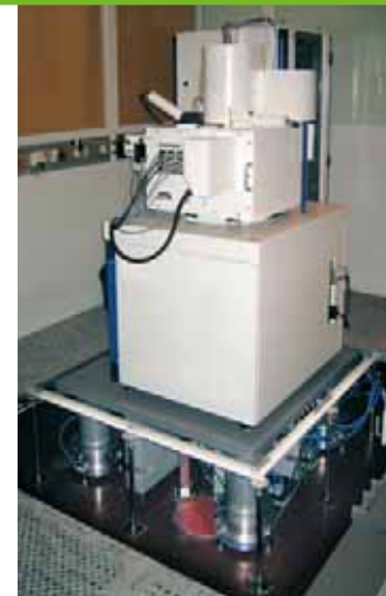
Anwendungsbeispiel: Elektronenmikroskop auf schwingungsisolierter Plattform
