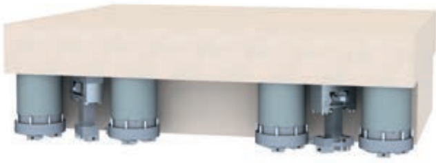
Aktive Schwingungsisolierung AIS™ High Performance von Bilz, welche den 75 Tonnen schweren Fundamentblock mit GFK Kunststoff-Armierung auf einem Luftkissen schwebend hält.
