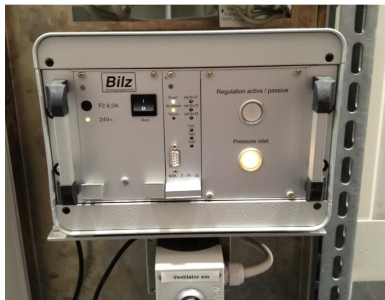
Abb. 3: Installiertes Höhenüberwachungssystem außerhalb der Kammer
